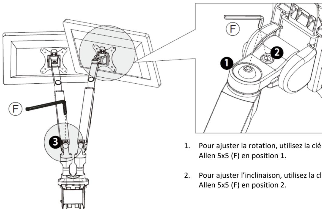
1. Pour ajuster la rotation, utilisez la clé Allen 5x5 (F) en position 1.
