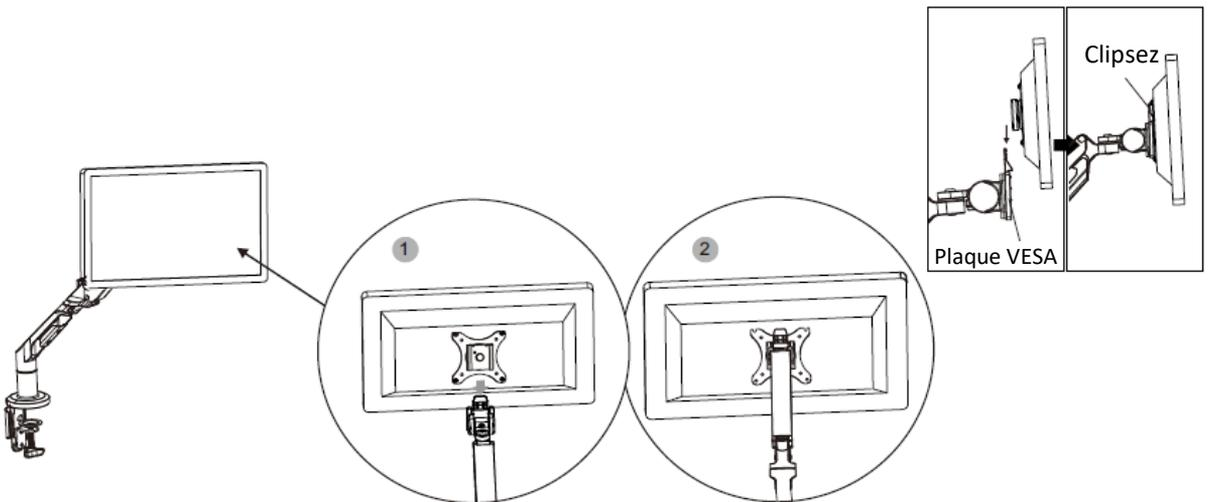
Insérez la plaque dans l'emplacement prévu sur le bras, de haut en bas, et assurez-vous qu'elle soit fermement clipsée.
